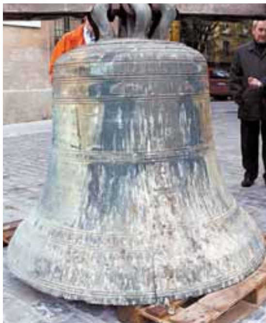
La ‘Gabriela’, antes. La imagen se tomó en octubre, cuando la campana dejó la torre. Estaba rajada y con el tono negro propio del paso del tiempo.
