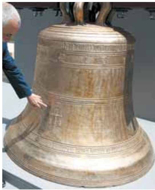
La ‘Gabriela’, ahora. Los 2.408 kilos de bronce muestran su tono natural. La grieta ya está soldada y en el proceso “sólo” se han perdido tres de sus letras.
